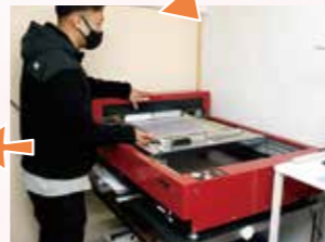
③ゴッコプロ本体にアルミ枠をセットしてスタートスイッチを押す。サーマルヘッドが動いて約2分で製版が完了。
