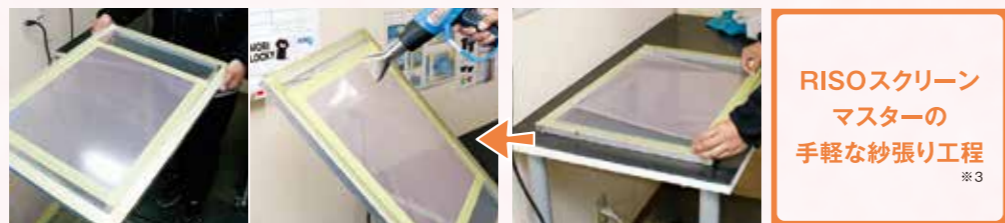
②貼り付けたマスターにヒートガンで熱風をあててテンションが張った状態(写真⑤)にする。
