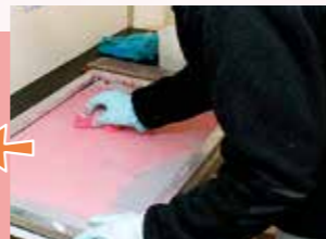
1,000枚以上のTシャツを印刷するには、補強剤を塗布することで耐性をアップする。
