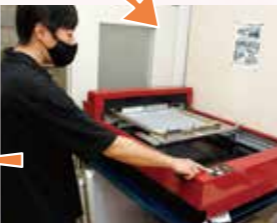
③スタートスイッチを押す。サーマルヘッドが動いて約2分で製版が完了。
