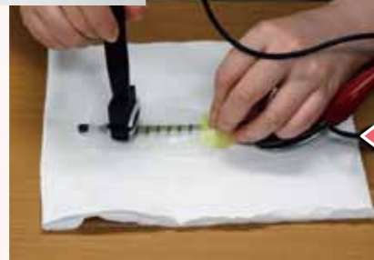
マスターに電解液を浸して版の上から丁寧に。交流にする と黒っぽく、直流にすると白っぽい刻印になる。
