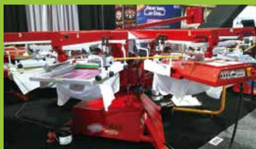
Tシャツ用自動印刷機に設置可能な大判枠に対応
