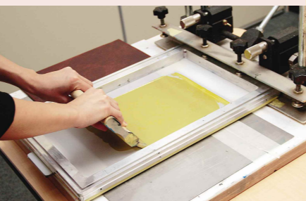
布よりもギャップ（印刷対象物との隙間）を少し多めにしてスキージすればインクの糸引きが抑えられる。
