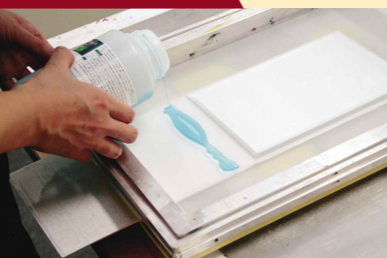
インクの代わりにエッチング剤を版に乗せてスキージする。
