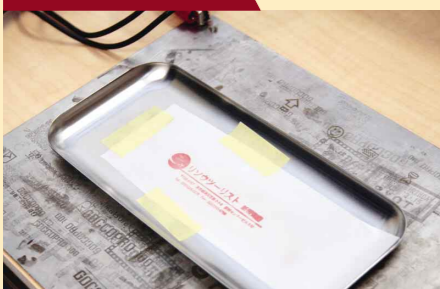
金属板にプラグを繋いで、刻印対象物を乗せる。電解液は金属によって種類が違うので注意する。
