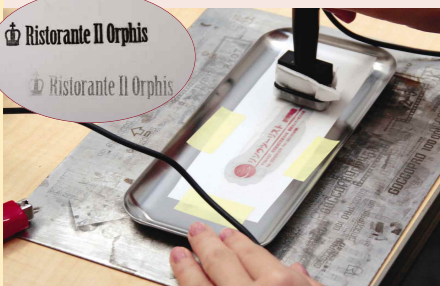
マーカに電解液を浸して版の上から丁寧にさする。交流にすると黒っぽく、直流にすると白っぽい刻印になる。
