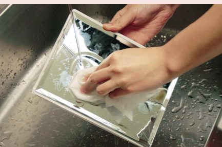
20分程度放置した後、水洗いをしてエッチング剤を取り除けば完成だ。
