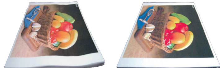
水性インクの場合は、波打ち・カール等の変形が起きやすい
