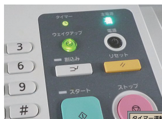
操作パネル上の ウェイクアップキーと タイマー運転表示
