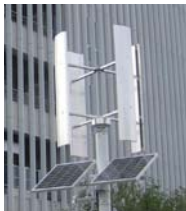
ハイブリッド式発電システム
