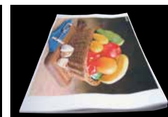
波打ちやカールなどの変形が起こりやすい水性インク
