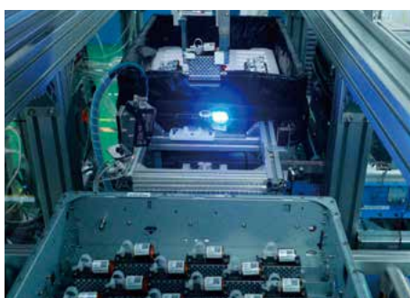
インクジェット印字ヘッドユニットの組み立て治具を内製
